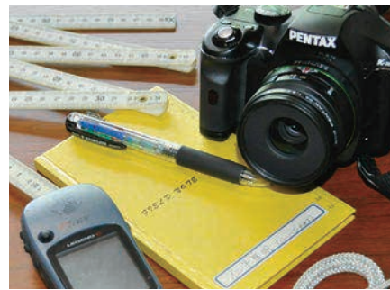
▲現地調査の必須アイテムはカメラ、携帯用GPS、フィールドノートと4色ペン、折れ定規。
